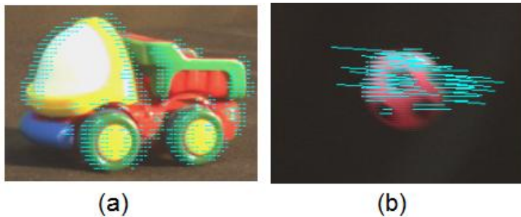
Figura 2.9 Flujo óptico generado para un objeto estático (a) y un objeto móvil (b)
