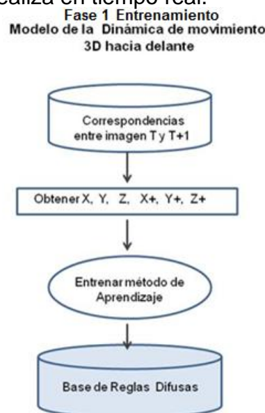
Figura 3.1 Fase de entrenamiento del sistema (Modelado de la dinámica de movimiento 3D hacia adelante)
