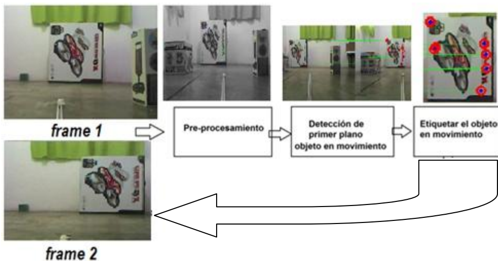
Figura 1.2 Diagrama del sistema para detección de objetos en movimiento con cámara móvil
