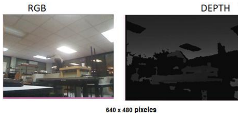
Figura 4.2 Imagen RGB e imagen de profundidad obtenidas con el dispositivo KINECT
