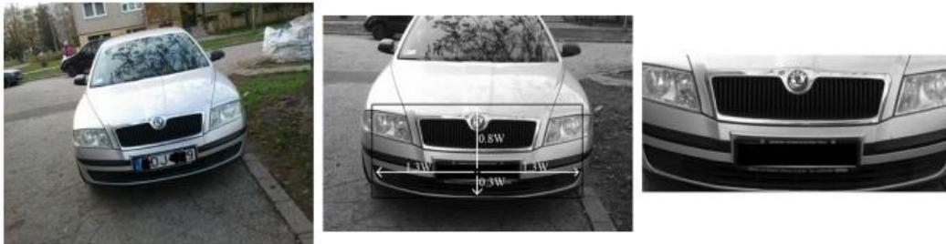
Figura 3.13 Frontal original (izquierda una parte de la matrícula es oscurecida por el anonimato), la compensación de la rotación, número de placa de identificación y la extracción de retorno de la inversión (en el centro), y el retorno de la inversión extraído (derecha) (Tanacs & Varjas, 2013).
