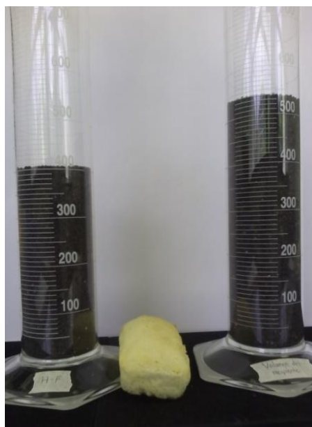
Figura 13. Análisis de volumen específico con semillas de mostaza
