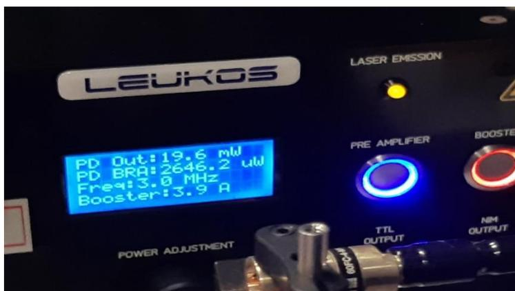
**Figura 24:** datos de salida del láser súper continuo donde podemos observar la potencia con la cual se realizó el experimento que es 3.9 Amperes de potencia con una frecuencia de 3.0 MHz
