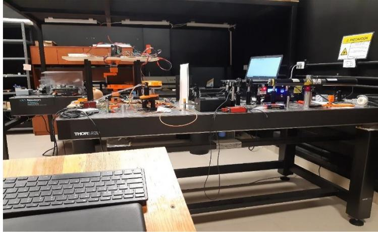
**Figura 20:** mesa de trabajo, arreglo experimental, laboratorio de optomecatrónica material empleado en el experimento, inicio de la medición de la dependencia angular y espectral de la reflectancia de una película delgada de oro en la configuración de Kretschmann.
