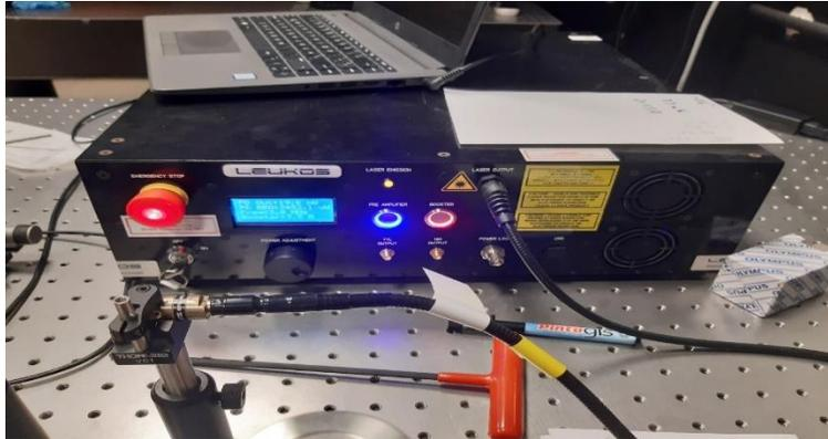
**Figura 22:** fibra óptica utilizada para la salida del láser supercontinuo
