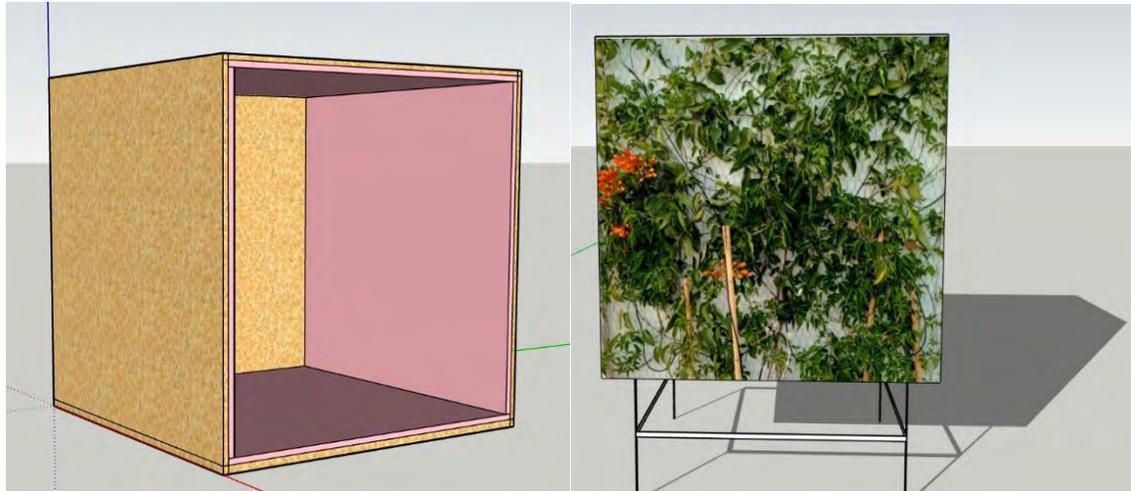
Figura 4.1. Diseño de los módulos de prueba, y representación gráfica de la colocación de la fachada verde sobre la pared sur del módulo de prueba.
