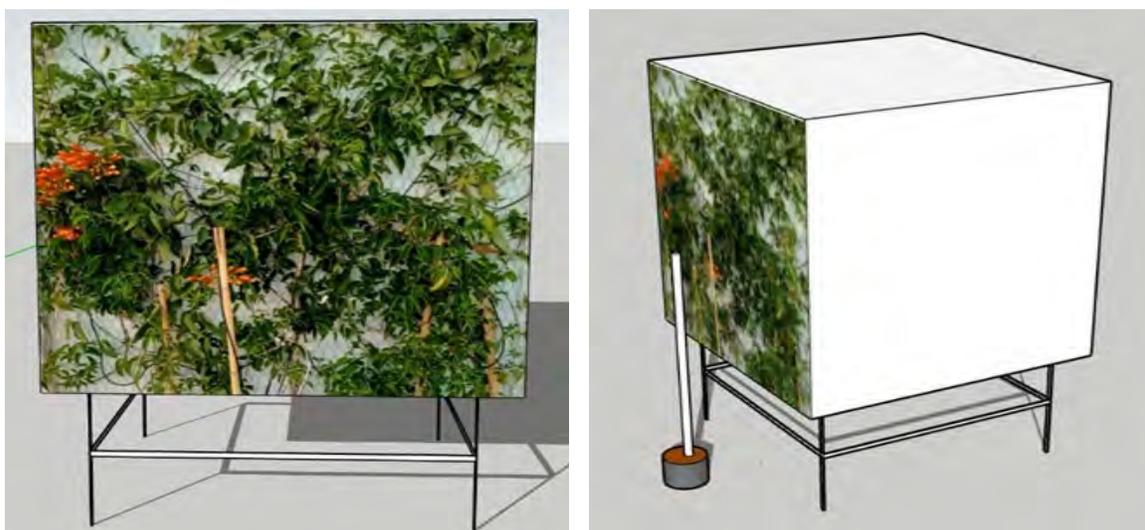
Figura 4.6. Distribución de los sensores TD\_DS18B20 colocados directamente sobre la vegetación y a una posición estratégica de 30 cm distanciado de la fachada verde.
