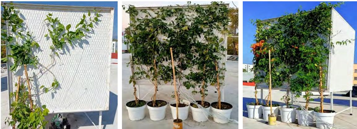
Figura 4.4. Colocación y evolución de la planta trepadora sobre la malla metálica en la pared sur del módulo experimental.
