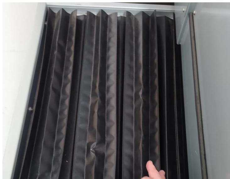
Imagen 11: Fuelle del eje X de la máquina Sodick.
