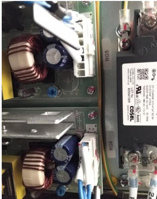
Imagen 24: RG5 y RG6, a un costado de unidad PMOS, en el panel lateral.
