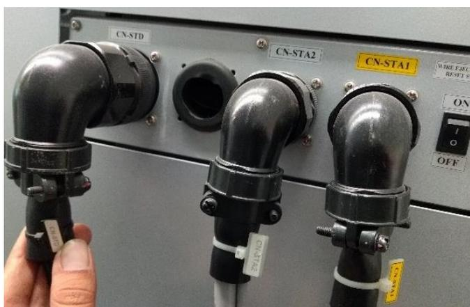
Imagen 12: Conexiones rápidas del tanque.
