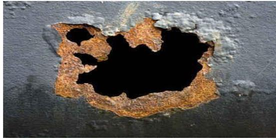
**Nota.** Adaptado de la corrosión por picado[Fotografía], por Ingeniería Mecánica, 2019, Flickr(corrosion por picado - Bing images).
