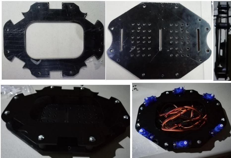
Figura 28 Muestra y armado de la base del Robot Hexápodo.
