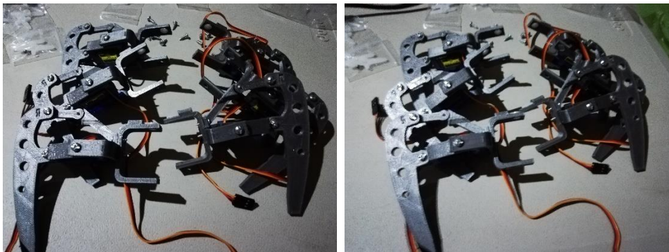
Figura 27 Muestra de terminación de ensamble de las patas o soportes del Robot Hexápodo.
