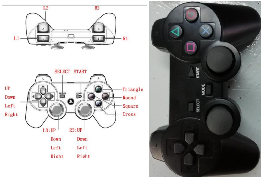
Figura 33 Control de ps2 e identificación de sus componentes.
