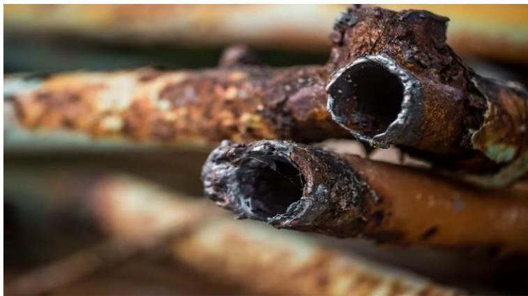
**Figura 2.** Sección transversal de una tubería con acumulación de sarro.
