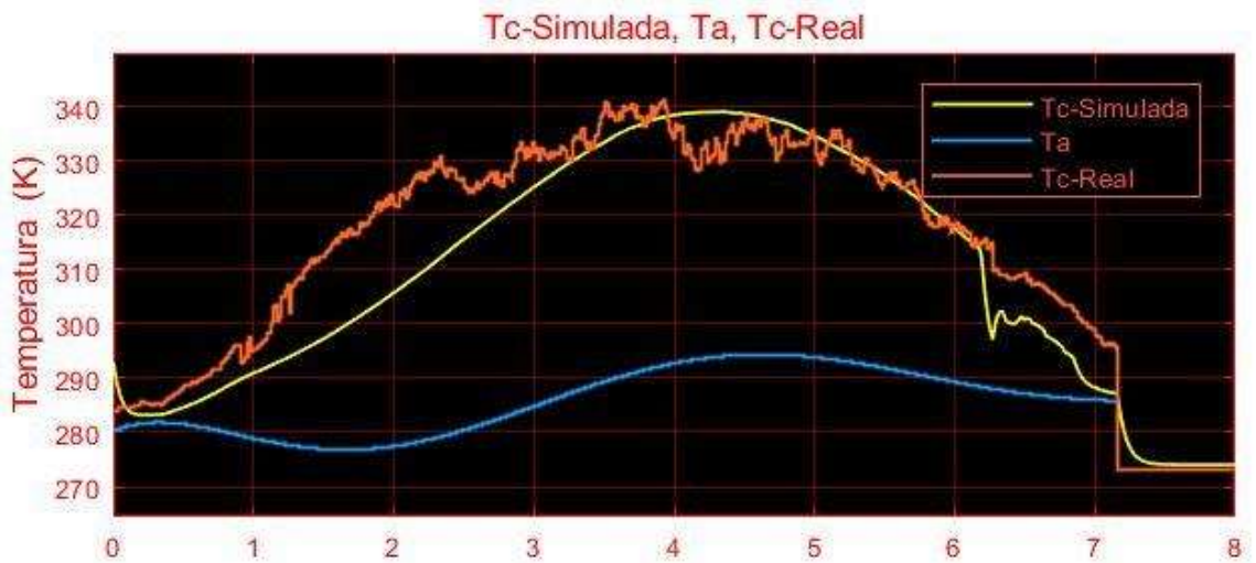
Figura 6.35 “Curva de Temperatura de Celda Real y Simulada M-Convección”
