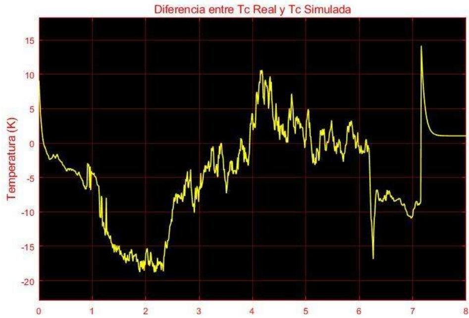
Figura 6.40 “Variación de Temperatura de Celda Real y Simulada M-Convección”
