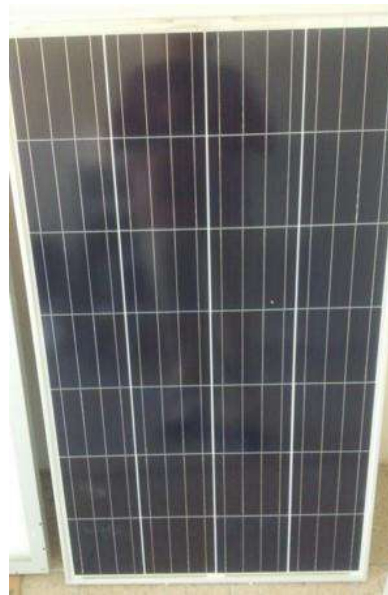
Figura 3.4 “Modelo celda fotovoltaica del tipo policristalino”
