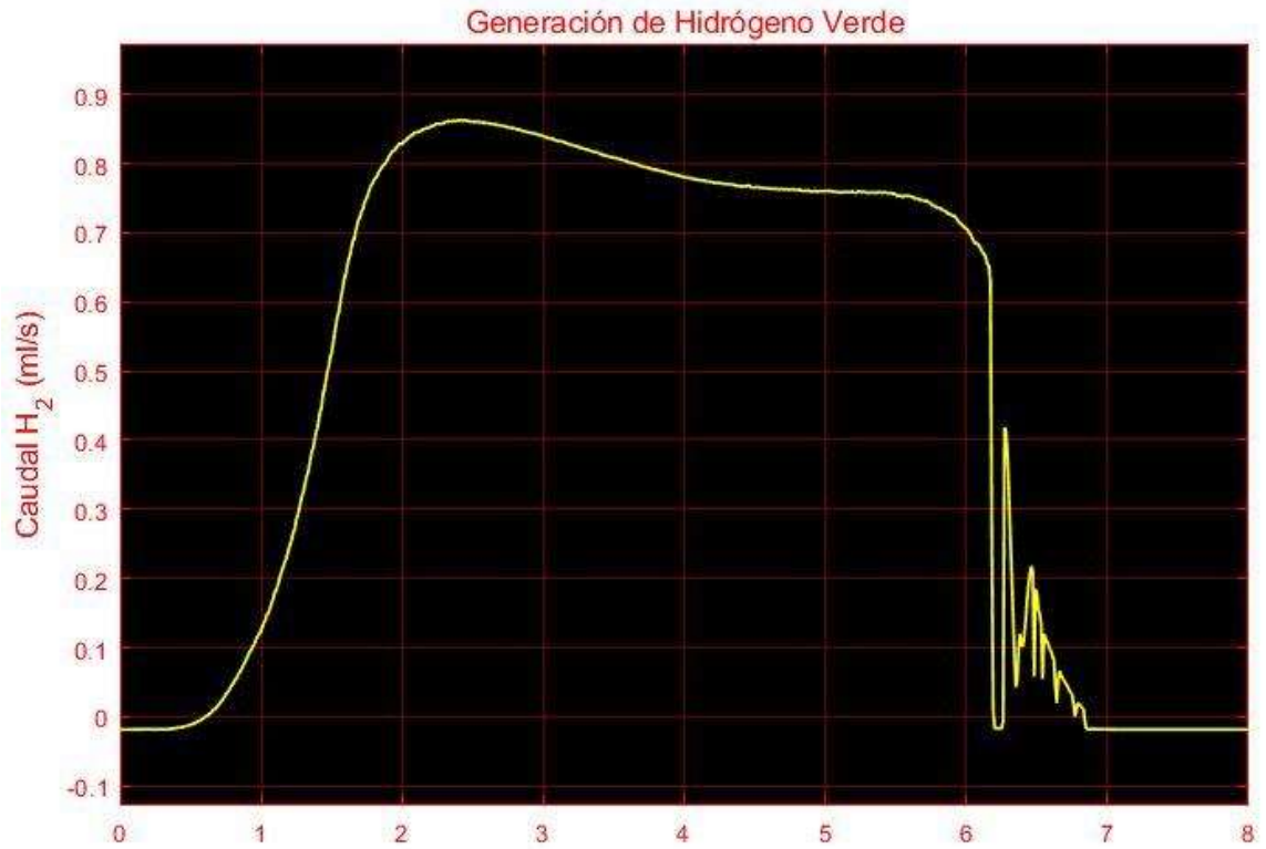
Figura 6.53 “Curva de Hidrógeno Generado en M-Radiación”
