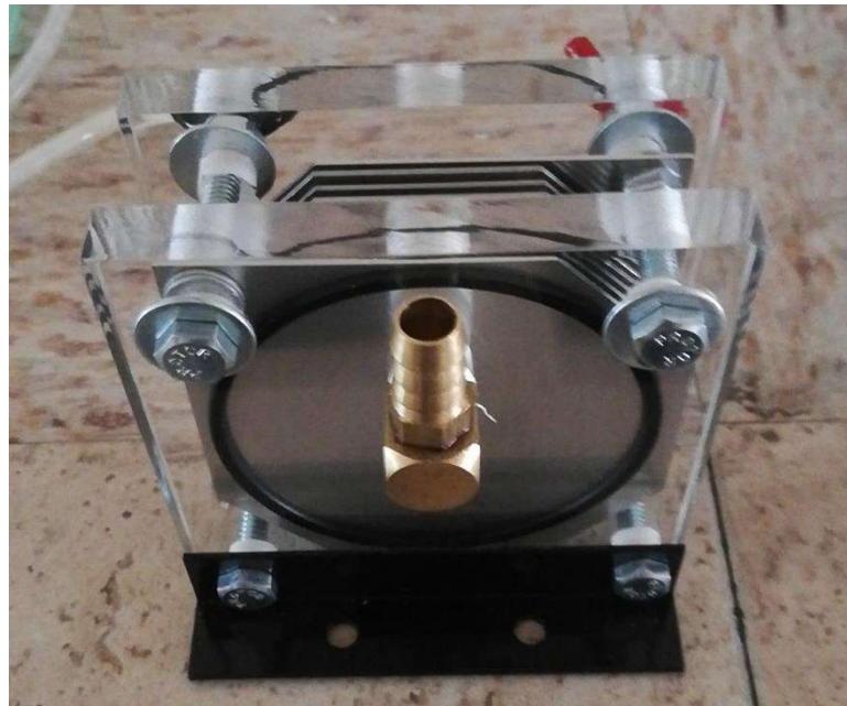
Figura 3.12 “Modelo de Celda de Hidrogeno HHO”
