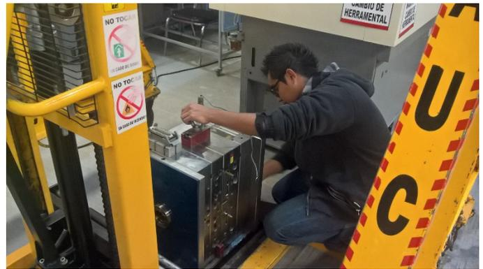
Ilustración 29 Limpieza interna de molde
