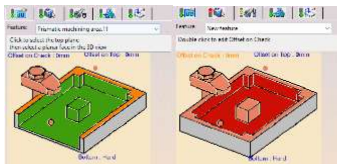
Figura 34 Modos de desbaste en caja.
