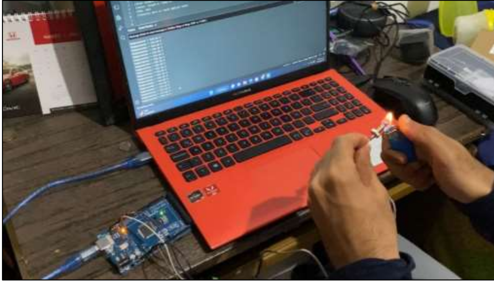
Figura 29. Prueba de monitoreo de temperatura en monitor serial con un termopar tipo K.
