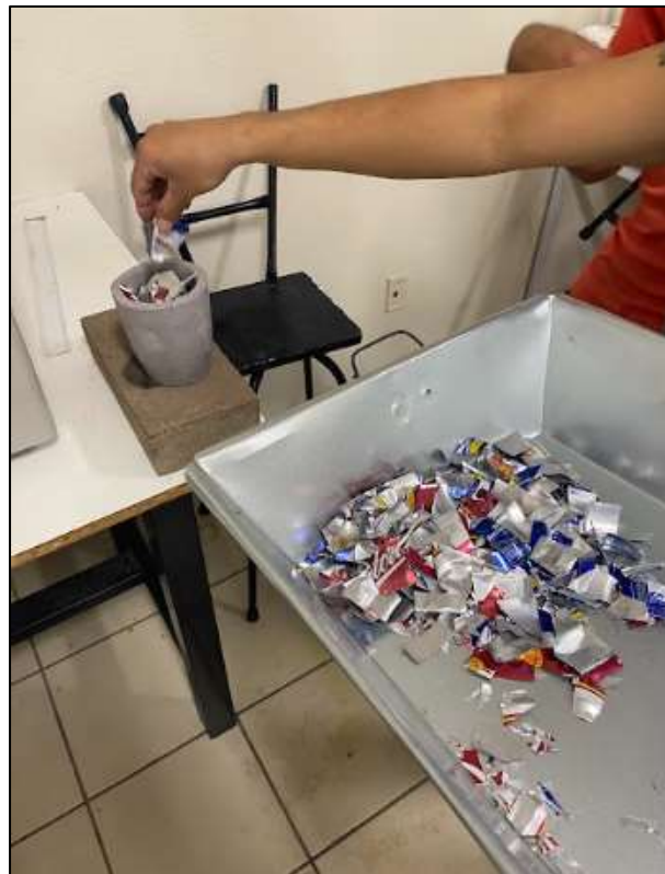
Figura 23. Primera prueba sin lijar las latas y cortadas en pedazos pequeños.
