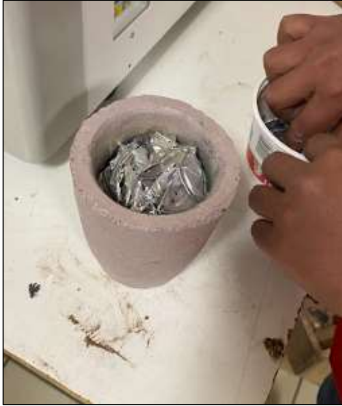
Figura 24. Segunda prueba lijando las latas y cortadas en pedazos pequeños.
