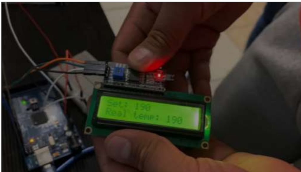
Figura 50. Controlador PID estabilizando la temperatura real a temperatura del SetPoint.
