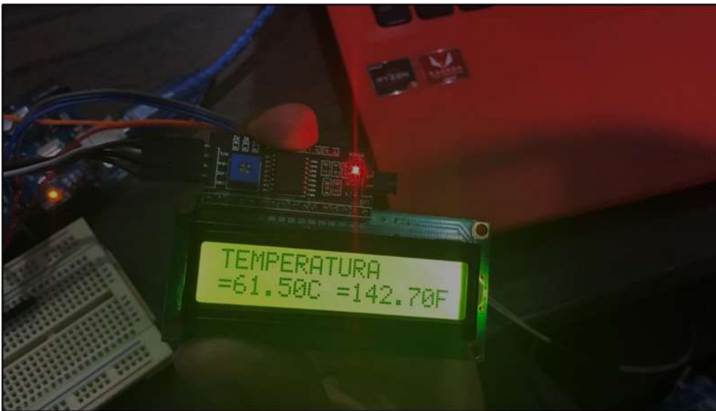
Figura 32. Monitoreo de la temperatura en una pantalla LCD 16x2 con modulo I2C.
