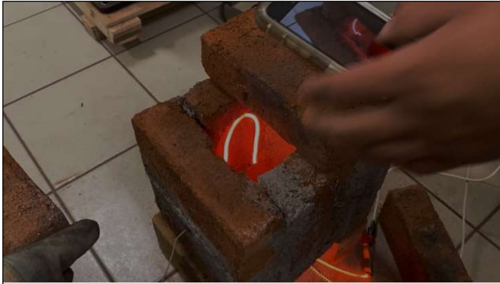
Figura 35. Prototipo de horno eléctrico en funcionamiento.
