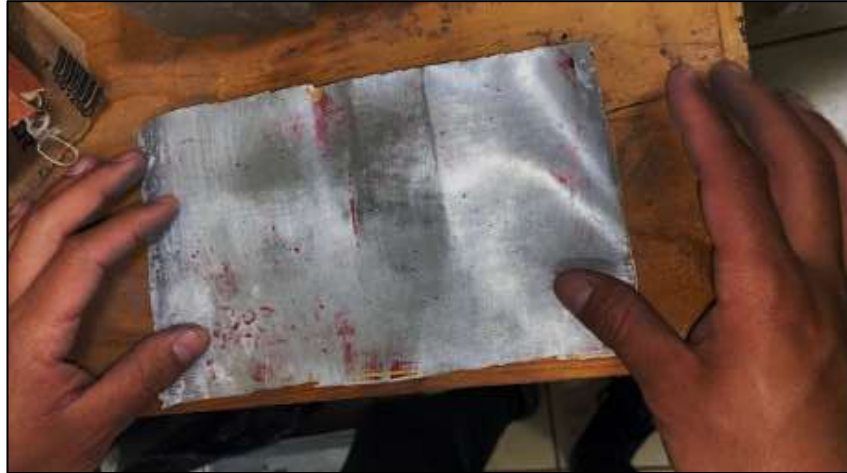
Figura 25. Tercera prueba lijando y utilizando solo el cuerpo de las latas sin la tapa.
