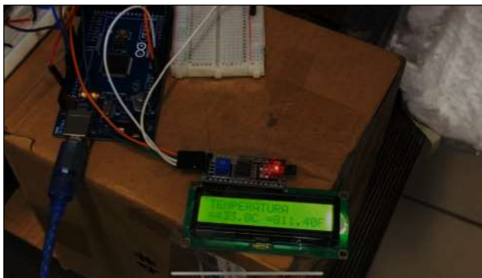
Figura 40. Pantalla LCD evidenciando el correcto funcionamiento del termopar tipo K.
