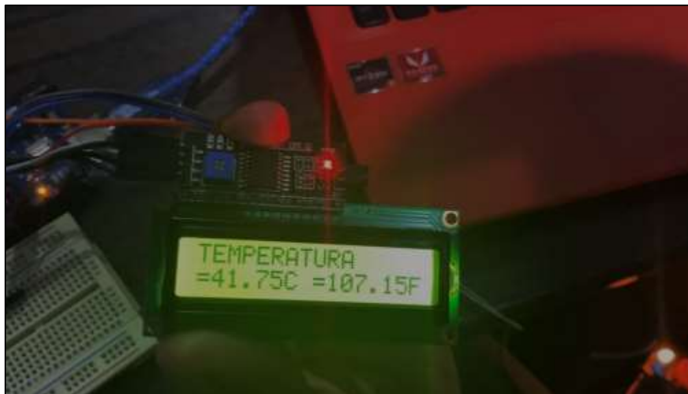
Figura 39. Pantalla LCD mostrando el aumento de temperatura.
