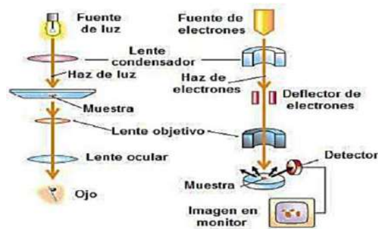
Figura 2.13: Comparación entre el microscopio óptico y el microscopio electrónico.
