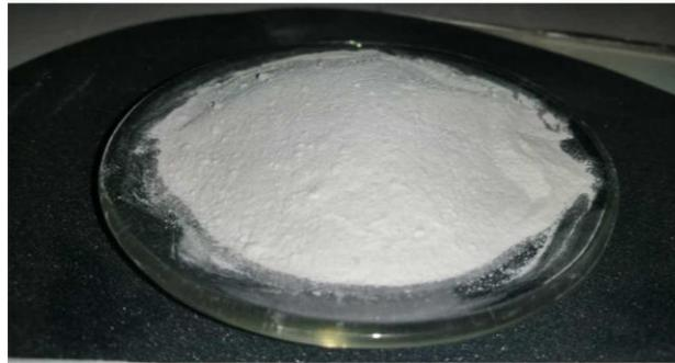
*Figura 3-2. Silicato de sodio obtenido a 150°C a partir de vidrio + NaOH.*
