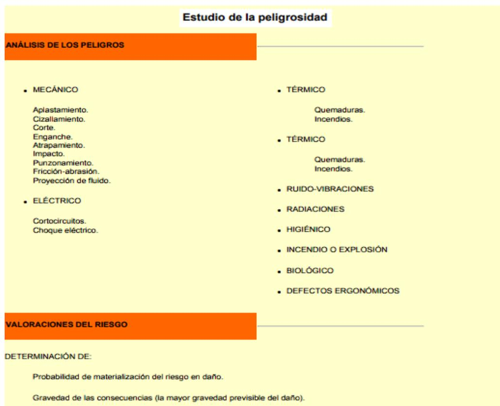
De acuerdo con la imagen 36 Medidas de seguridad en máquinas: criterios de selección. El prototipo posee peligros mecánicos como son aplastamiento, corte, atrapamiento estos en ambos sistemas (desespinado y corte) ya que se trabaja con rodillos y elementos afilados, también presenta peligro en la parte de transmisión de potencia.
