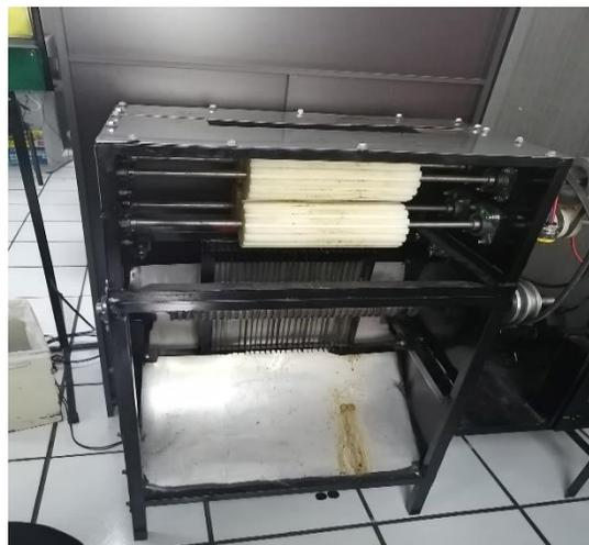
La máquina no cuenta con los elementos de seguridad para la integridad del personal, como lo son guardas de protección en transmisión de potencia, se observa en la imagen 2.
