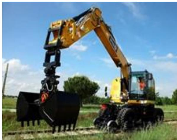
*Figura 11 Modelo de excavadora de cuchara bivalva-Modelo KINSHOFER C18VE*
