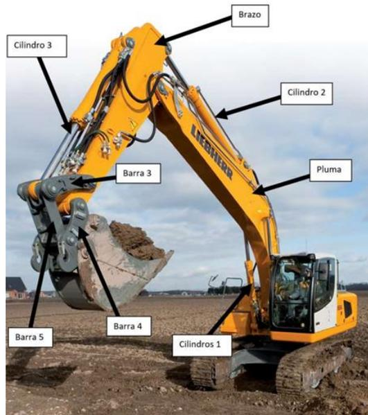
*Figura 13 Descripción de partes de pluma y brazo*
