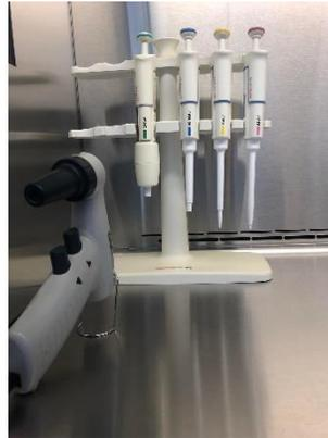
**Figura 14. Micropipetas**
