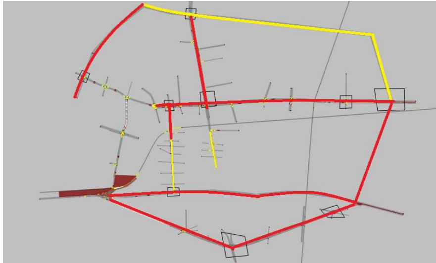
Figura 4. 4 Modelo de simulación de ciclovías propuesto (amarillo: ciclovía existente, rojo: ciclovía propuesta)
