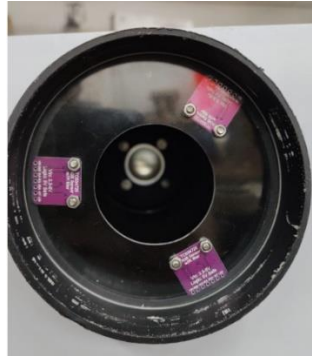
Figura 31: Instalación de la base soporte de los sensores RGB y de intensidad luminosa, dentro de la cámara de aislamiento de luz del medio ambiente.
