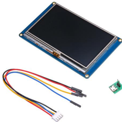
Figura 17: Pantalla táctil TFT marca NEXTION y sus accesorios para programación vía puerto serie.
