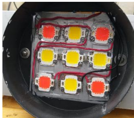
Figura 28: Instalación la matriz de leds de potencia visto desde el frente de la tapa, lo que será la fuente emisora de luz dentro de la cámara oscura.
