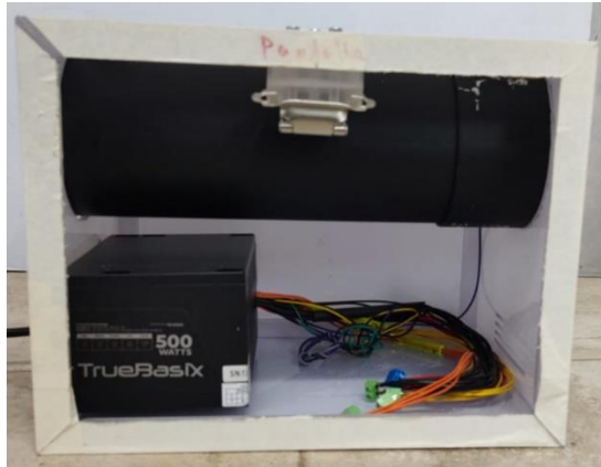
Figura 29: Instalación del tubo que funge como cámara aislante de la luz del medio ambiente, la fuente de alimentación principal y la bisagra de la pantalla touch.
