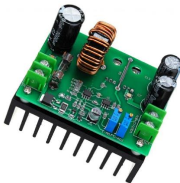
Figura 20: Fuente de poder conmutada boost de 600 W.
