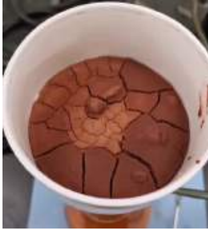
Figura 2.4 Filtrado al vacío del tratamiento ácido.
