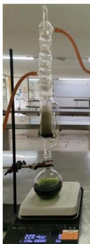
**Figura 2.2** Dispositivo de extracción Soxhlet.
