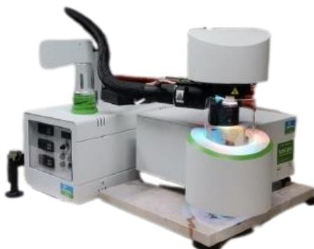
**Figura 2.7** Termobalanza TA Instruments (TGA 8000)
