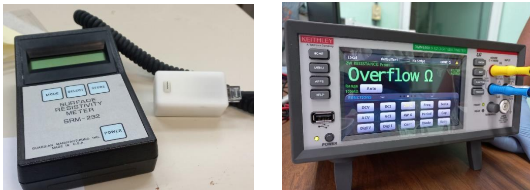
Figura. 4.5. Equipos empleados para medición de 4 puntas, a) arreglo lineal b) en los extremos.
