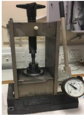
Figura 4.4 Prensa empleada para compactar los polvos de las perovskitas.
