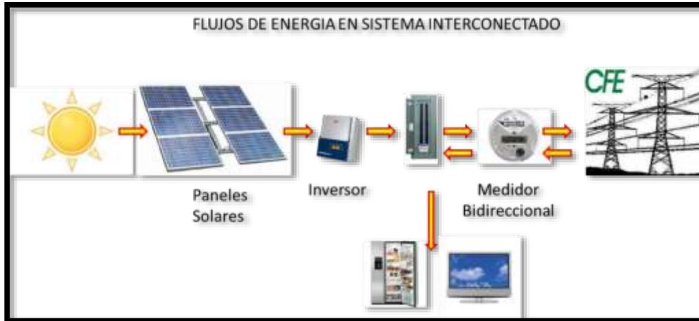
Figura 27 Flujos de energías en sistema interconectado
