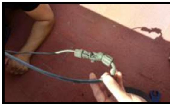
Figura 52 Falla en Conectores MC4 por mal Ponchado del cable
