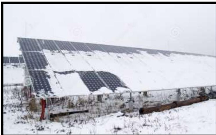
Figura 65 Daños a módulos por causas climáticas
