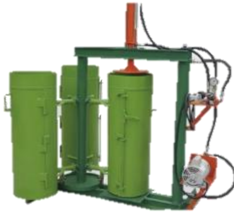
Figura 2. 4 Silo prensa vertical hidráulica
