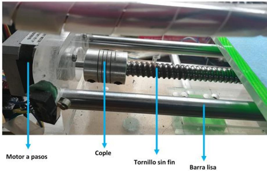
Figura 14. Mecanismo eje X.
