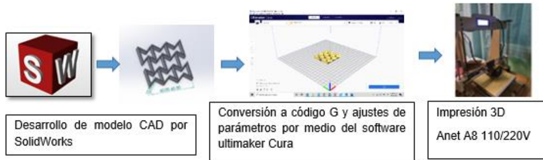
Figura 13. Metodología de desarrollo de muestra Auxética por SolidWorks y ajustes de parámetros en ultimaker cura.
