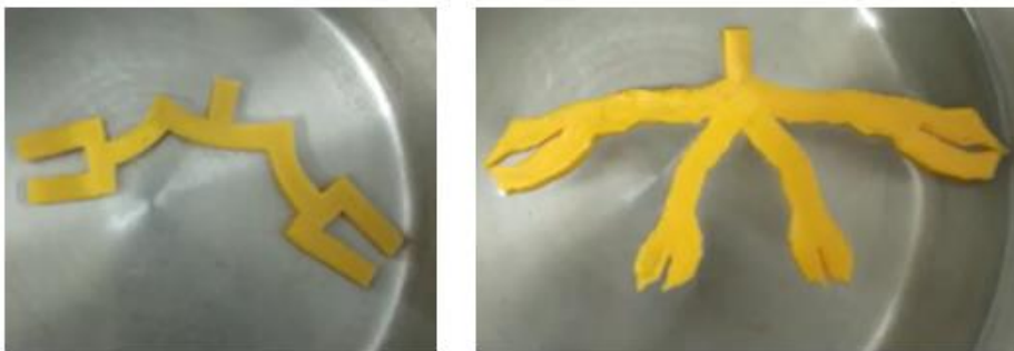
Figura 34. Deformación de muestras impresas
