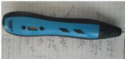
Figura 11. Pluma de impresión 3D marca Joky 1.75mm
