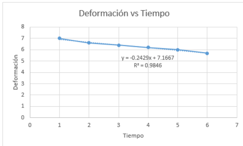
Figura 91. Gráfico Deformación vs Tiempo y ecuación de regresión lineal para estructura auxética de 5mm de espesor a 75°C
