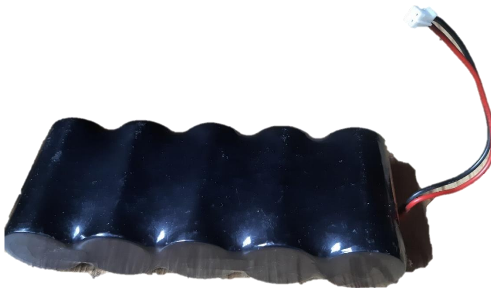
Figura 24. Paquete de baterías para energizar la estación meteorológica
