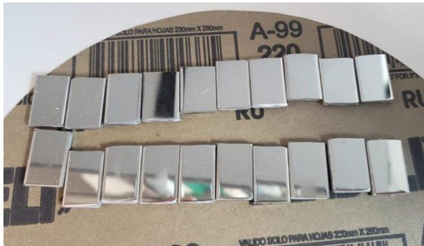
Figura 11. Sustratos con acabado espejo.
