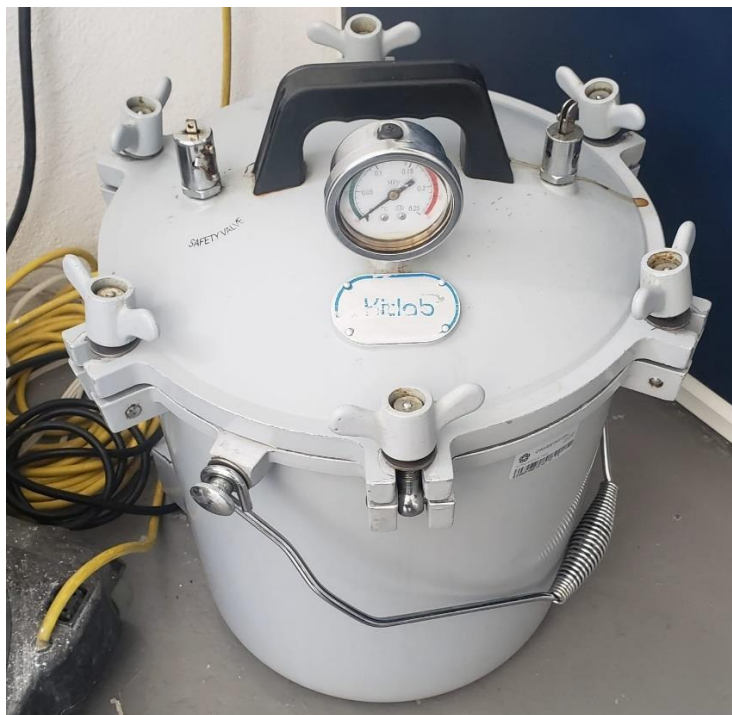
Figura 13. Tanque de presión.
