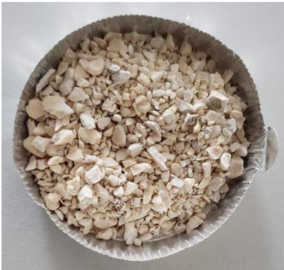
Figura 18. Astillas después de la primera molienda.
