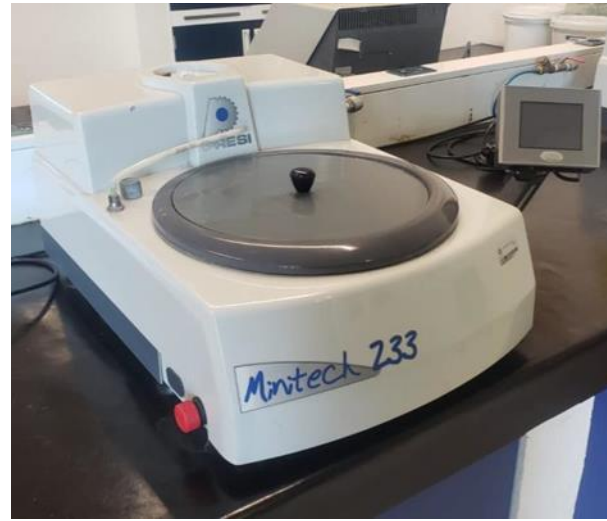
Figura 10. Pulidora PRESI Minitech 233 .
