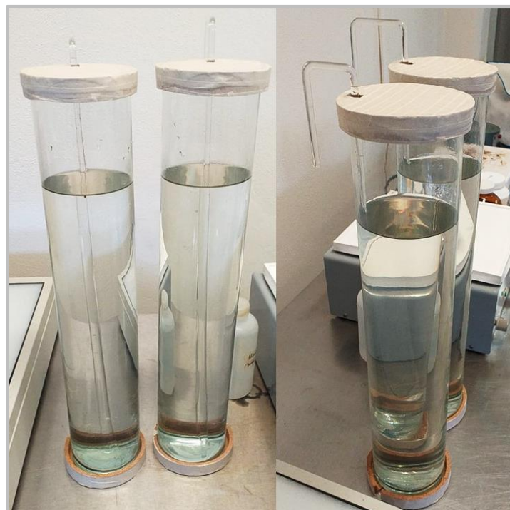
Figura 11. Adaptación de biorreactores de vidrio.
