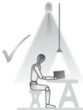
Ilustración 19 Se recomienda el uso de dos tipos de iluminación para tareas delicadas.
