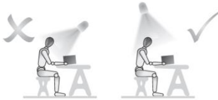
Ilustración 19 Cuide que la luz no caiga de manera directa ni provoque sombras en el área de trabajo.
