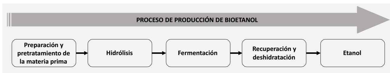
Figura 1.1: Proceso general de la producción de bioetanol
