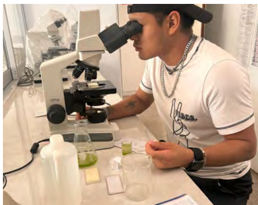
Figura 3.20: Fotografía de como se llevo a cabo el procedimiento para el conteo celular con la cámara de Neubauer y un microscopio óptico.
