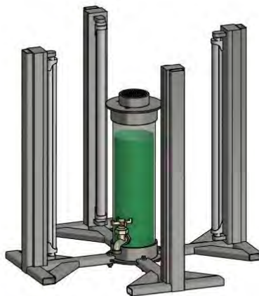
Figura 2.1: Ejemplo de un fotobiorreactor de columna de burbujas para cultivo de microalgas. Tomado de González-Lazo et al. (2019) .
