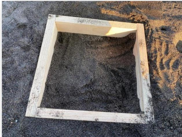
Figura 17. Cuadrante de madera utilizado en el muestreo de sedimentos
