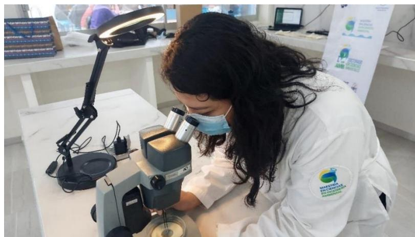
Figura 21. Identificación visual de microplásticos por medio de Microscopio óptico en el Laboratorio de Investigación y Recursos Acuáticos (LIRA).
