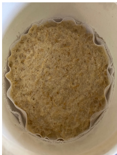
Figura 21. Filtrado de bagazo blanqueado con NaCl 2 .
