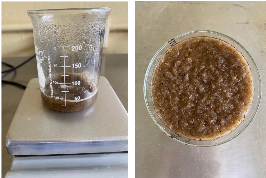
Figura 28. Elaboración de biopolímero composición 75 % Fibra y 25 % celulosa.
