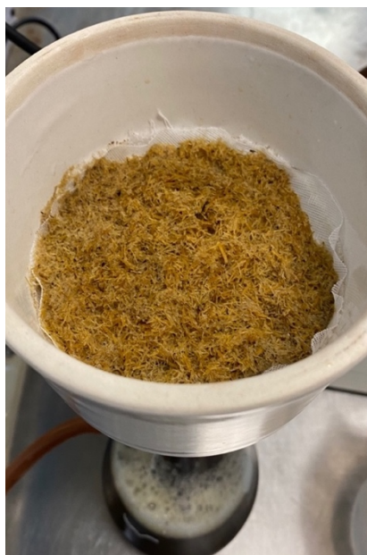
Figura 19. Filtración de bagazo tratado con NaOH.
