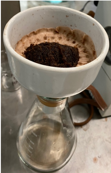
Figura 12. Filtrado de cascarilla tratada con NaOH.
