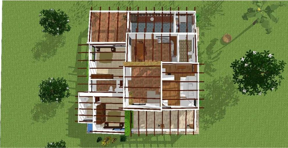
Figura 5.6 Planta arquitectónica con vigas de madera
