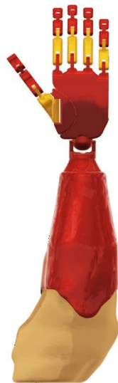
Figura 75. Ensamblaje del conjunto del muñón-socket con la prótesis de antebrazo.
