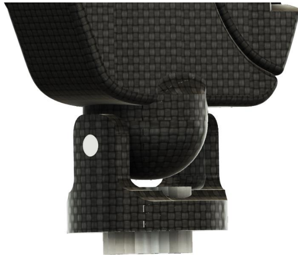
Figura 63. Saliente extruido integrado a la estructura de la mano para el ensamble de ambos mecanismos.
