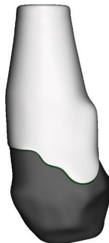
Figura 72. Modelado del antebrazo del socket sobre el muñón del miembro amputado en sólido de malla.
