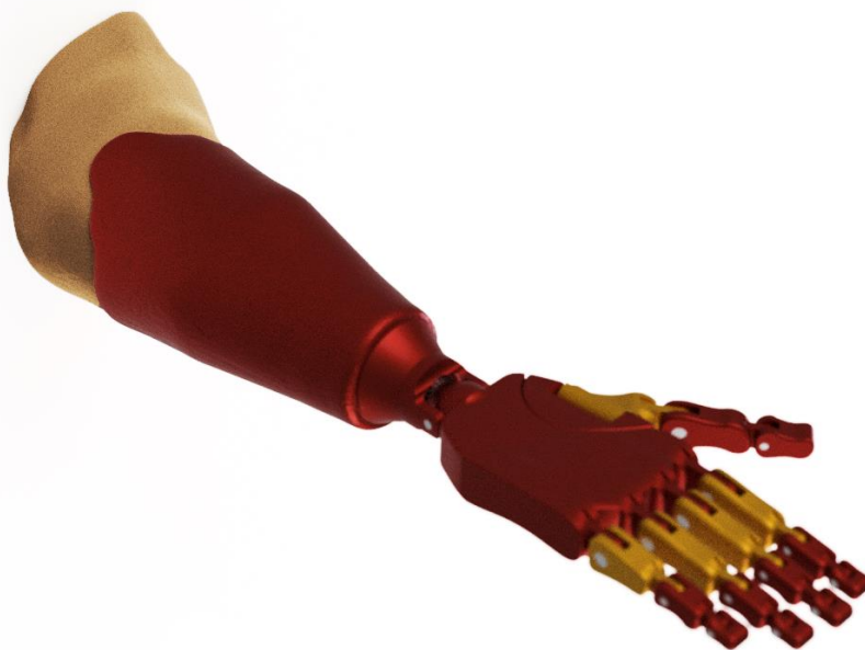
Figura 76. Renderizado de la prótesis de antebrazo desde una vista isométrica.
