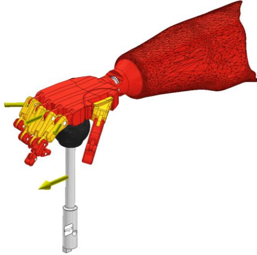
Figura 92. Ensamblaje de la palanca de velocidades del automóvil con la prótesis.
