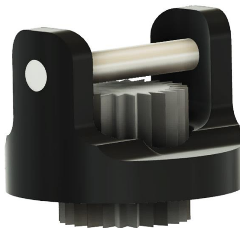
Figura 62. Mecanismo de rotación y bisagra integrado que realiza los movimientos de la muñeca.
