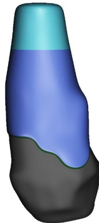
Figura 71. Modelado del antebrazo del socket sobre el muñón del miembro amputado.
