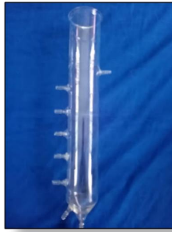
Anexo 6. Reactor UASB.
