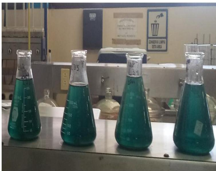
**Figura 22.** Se observa el aspecto final de la titulación para determinación de materia orgánica, con el cambio de coloración de café a color azul turquesa.
