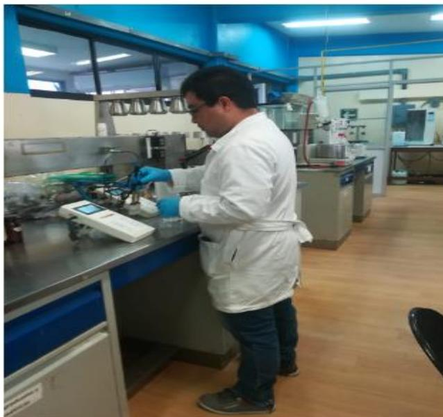
**Figura 20.** Medición de pH con la Sonda multiparamétrica Consort C6010.
