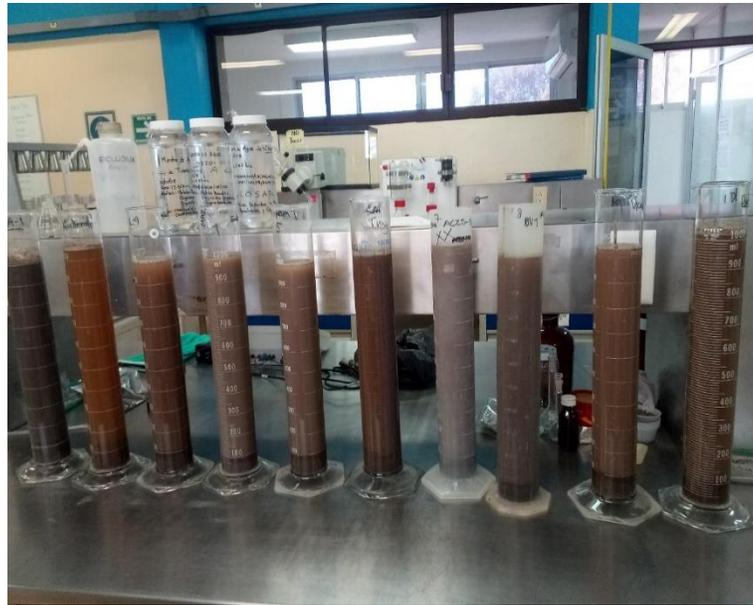
**Figura 23.** Se observa la diferencia en la suspensión de partículas del suelo, de las muestras colectadas.
