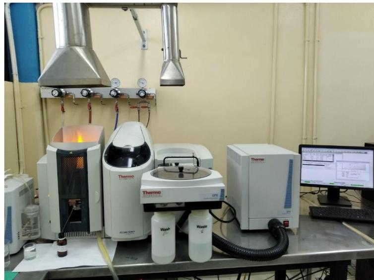
**Figura 24.** Análisis de muestras en el equipo de de absorción atómica Thermo Cientific Modelo Ice 3500 AA System (Thermo Scientific®)
