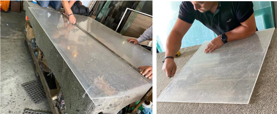
Figura 64: a) Se toman las dimensiones de las placas de acrílico. b) Proceso de corte de las placas.
