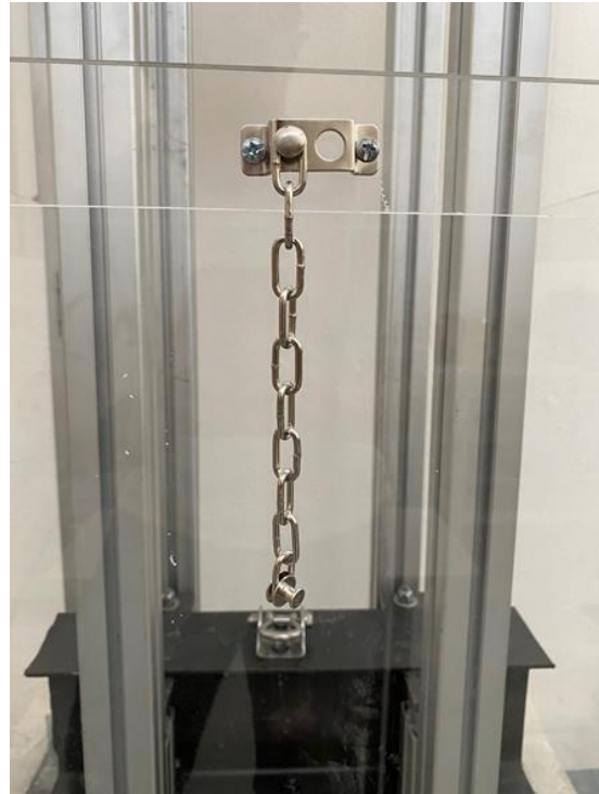
Figura 68: a) Sujetadores de pasador. b) Montaje de los sujetadores en las puertas de acrílico.
