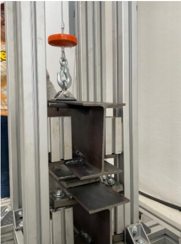
Figura 62: a) Montaje de la parte superior del percutor en el banco de pruebas. b) Unión de ambas partes del percutor.
