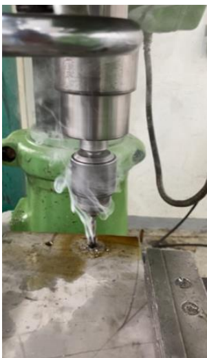
Figura 57: a) Barrenado de la placa de acero. b) Proceso de lubricación.
