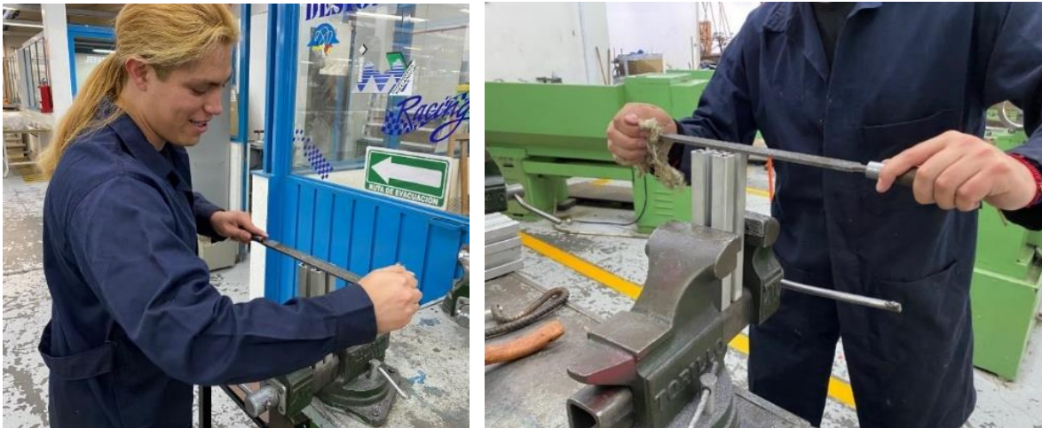
Figura 44: a) Proceso de limado del borde del perfil. b) Desbaste del filo del perfil de aluminio.
