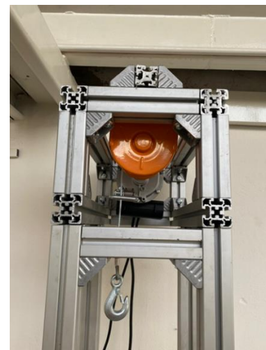
Figura 51: a) Banco de pruebas con el polipasto montado b) Cabina con el polipasto.
