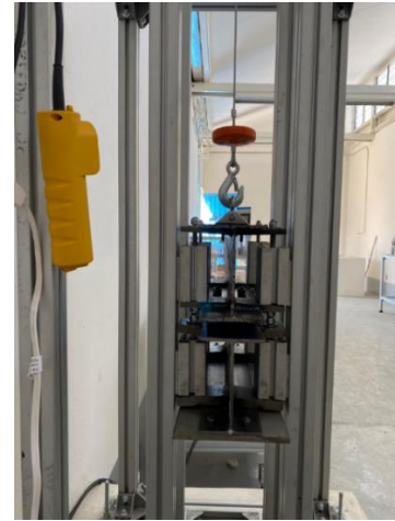
Figura 62: a) Montaje de la parte superior del percutor en el banco de pruebas. b) Unión de ambas partes del percutor.
