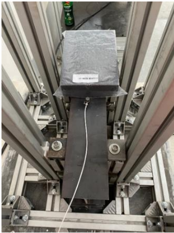
Figura 52: a) Área de la probeta es mayor a la del percutor. b) Proceso para desmontar el percutor.
