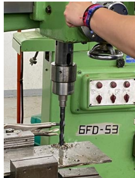
Figura 58: a) Colocación del taladro para realizar los orificios de 3/8 de pulgadas. b) Segundo proceso de barrenado.
