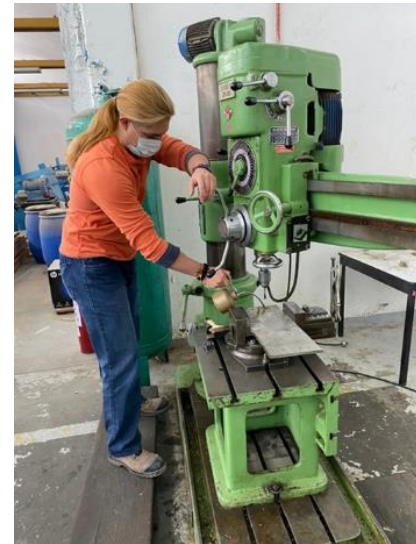
Figura 57: a) Barrenado de la placa de acero. b) Proceso de lubricación.
