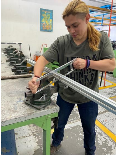
Figura 50: a) Corte de perfil de aluminio de 500 mm. b) Montaje del polipasto en la cabina.
