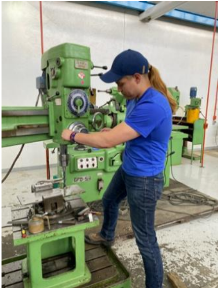
Figura 58: a) Colocación del taladro para realizar los orificios de 3/8 de pulgadas. b) Segundo proceso de barrenado.
