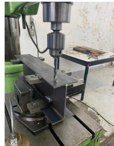
Figura 55: a) Colocación de la parte inferior del percutor en el taladro de banco. b) Barrenado de la parte inferior del percutor.
