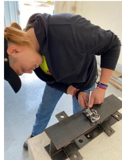
Figura 54: a) Colocación del anillo de unión en el percutor. b) Fijación del anillo con el percutor.
