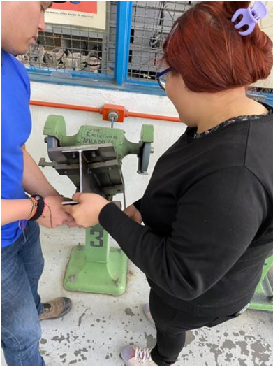
Figura 60: a) Proceso de esmerilado de la pieza. b) Parte inferior del percutor lista para ser montada.
