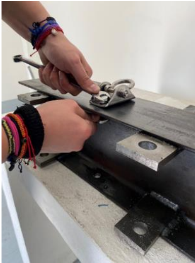
Figura 54: a) Colocación del anillo de unión en el percutor. b) Fijación del anillo con el percutor.
