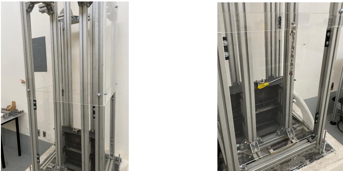
Figura 67: a) Placas de acrílico montadas en el banco de pruebas. b) Instalación de manijas.
