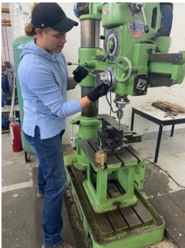
Figura 55: a) Colocación de la parte inferior del percutor en el taladro de banco. b) Barrenado de la parte inferior del percutor.
