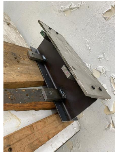
Figura 60: a) Proceso de esmerilado de la pieza. b) Parte inferior del percutor lista para ser montada.
