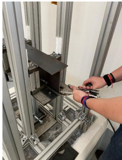
Figura 61: a) Colocación de la parte inferior del percutor en el banco de pruebas. b) Ajuste del percutor con los deslizadores.
