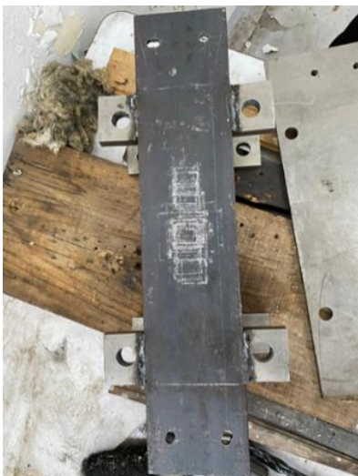
Figura 59: a) Maquinado de la parte inferior del percutor. b) Maquinado de la placa de acero.
