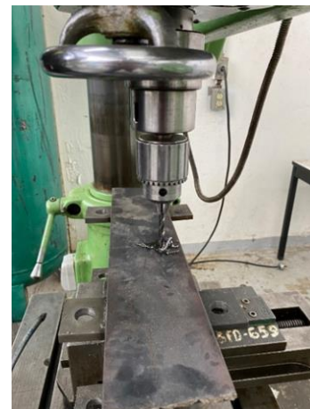
Figura 53: a) Colocación parte superior del percutor en el taladro de banco. b) Barrenado del percutor.
