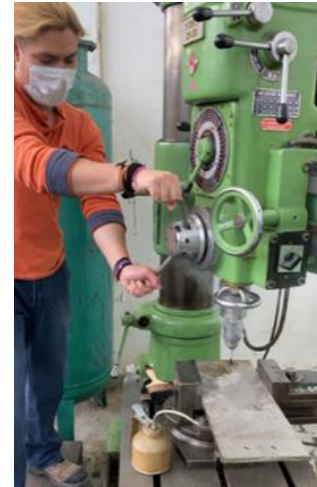
Figura 56: a) Marcaje de los puntos a barrenar en la placa de acero. b) Proceso de barrenado de la placa de acero.
