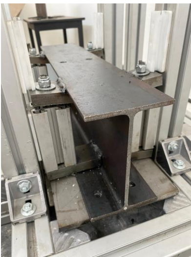
Figura 61: a) Colocación de la parte inferior del percutor en el banco de pruebas. b) Ajuste del percutor con los deslizadores.
