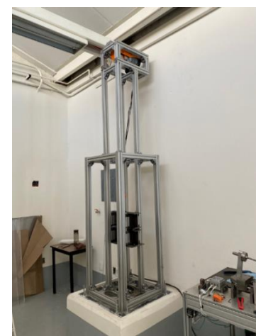
Figura 63: a) Vista frontal del percutor. b) Vista del banco de pruebas funcional y con el percutor montado.
