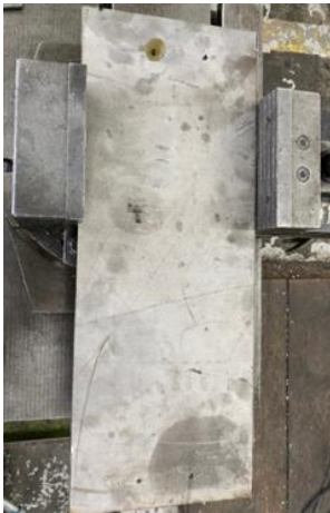
Figura 56: a) Marcaje de los puntos a barrenar en la placa de acero. b) Proceso de barrenado de la placa de acero.
