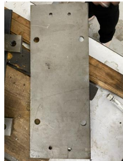
Figura 59: a) Maquinado de la parte inferior del percutor. b) Maquinado de la placa de acero.
