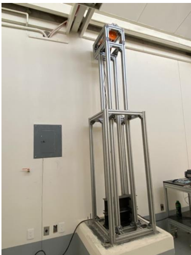
Figura 51: a) Banco de pruebas con el polipasto montado b) Cabina con el polipasto.
