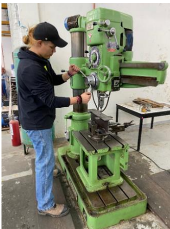
Figura 53: a) Colocación parte superior del percutor en el taladro de banco. b) Barrenado del percutor.
