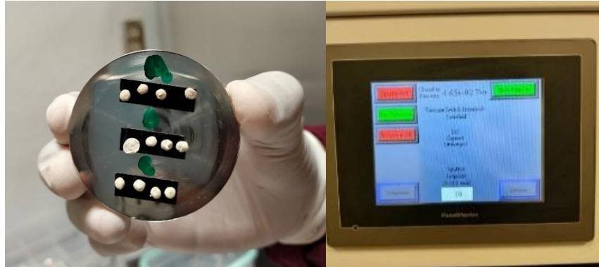
Figura 5. a) Montaje de muestras, b) Evacuación preliminar a alto vacío ( 4.8 \times 10^{-2} torr).
