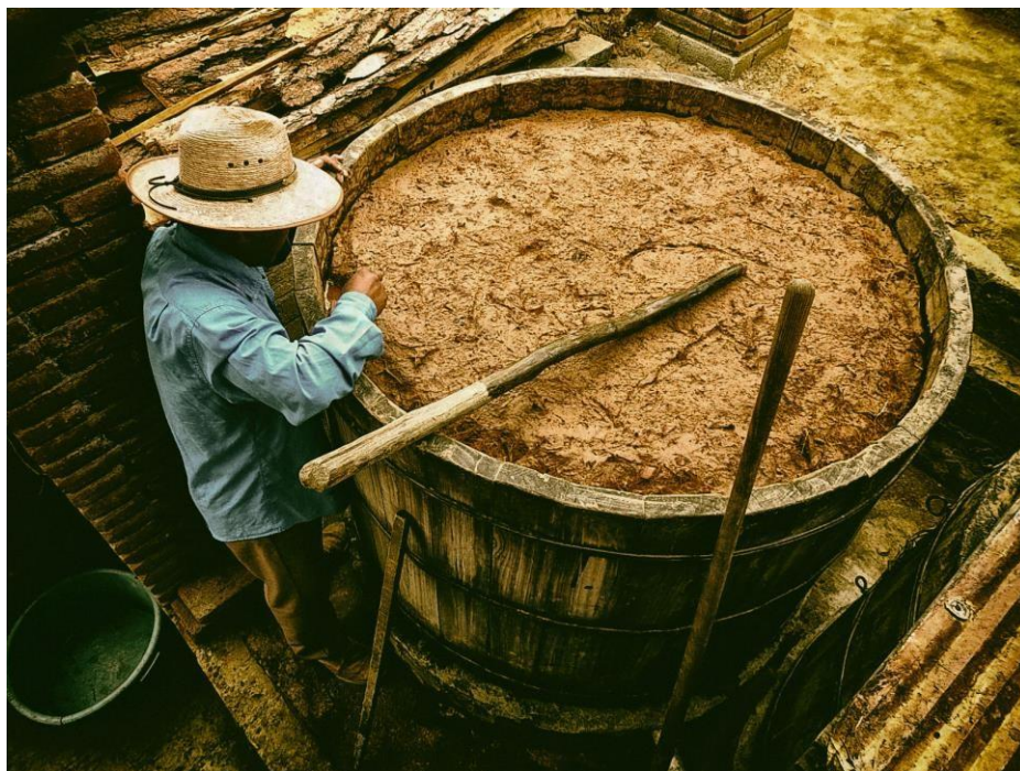
Figura 8. Fermentación en tinas de madera
