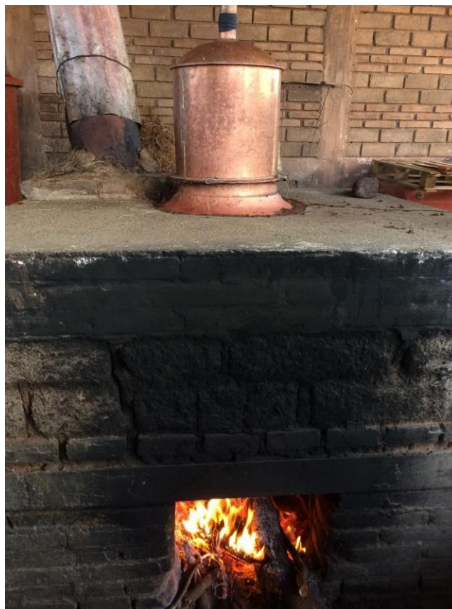
Figura 9. Destilación alambique de cobre
