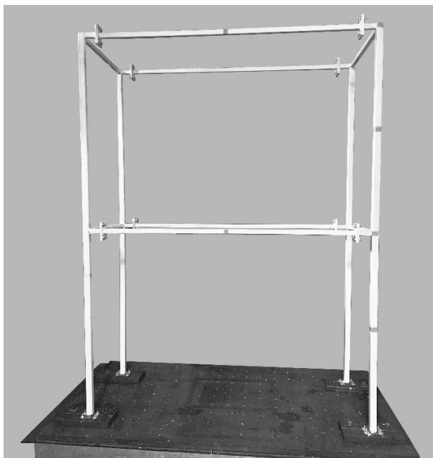
Figura 2. 3 Estructura de acero utilizada en la investigación.
