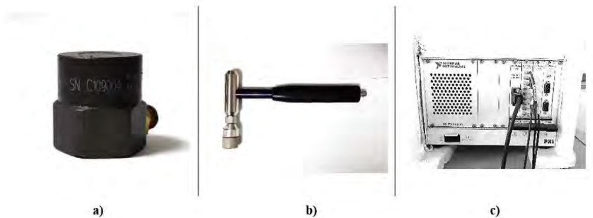
Figura 2. 8 Instrumentos de medición para el experimento. a) Acelerómetro, b) martillo de impacto y c) sistema de adquisición de datos.
