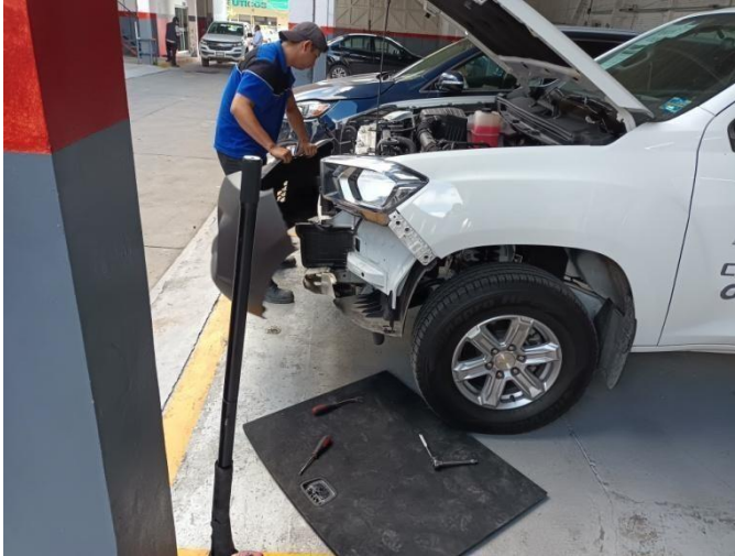
Imagen 12. Hojalatero reparación de fascia delantera
