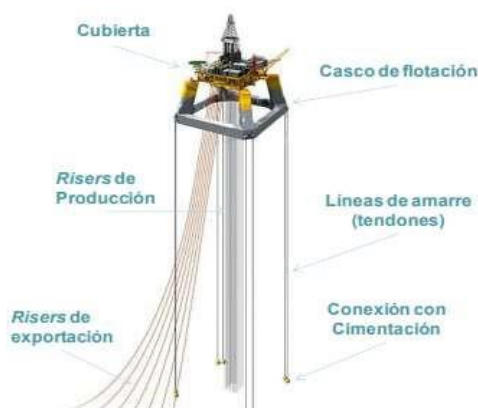
Ilustración 20. Componentes principales de un sistema flotante.
