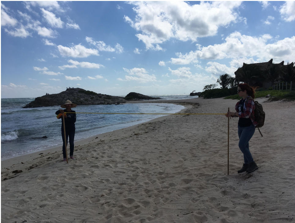
Imagen 3. Posición del ojo observador en el palo de madera, y la manera en cómo se tomaron las medidas. Posteriormente se sacaron los cálculos con la fórmula siguiente:
