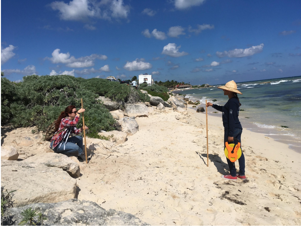
Imagen 2. Posición del ojo observador en el palo de madera, y la manera en cómo se tomaron las medidas. Posteriormente se sacaron los cálculos con la fórmula siguiente
