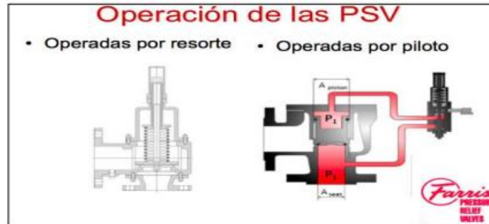
Ilustración 12 CONFIGURACIONES DE LAS VALVULAS DE SEGURIDAD
