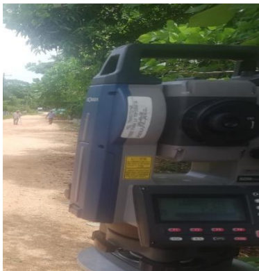
Fig. 24 Estación Total se utiliza para el registro eléctrico de datos
