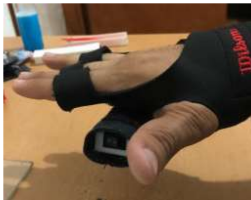
Fig. 4.12 Dispositivo de control adaptado al guante
