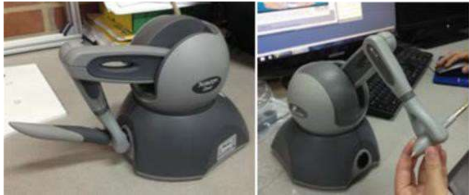
Fig. 2.1. Dispositivo háptico Omni-Phantom empleado para la evaluación de trayectorias.
