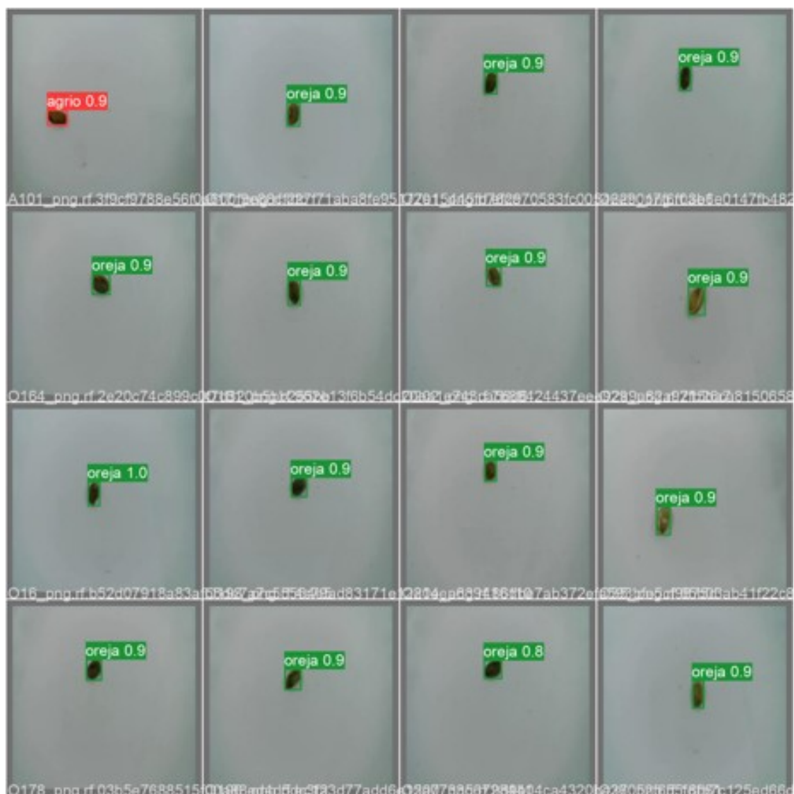
Figura 51: Resultados obtenidos en las pruebas de detección, identificación y clasificación de defectos en el café verde.
